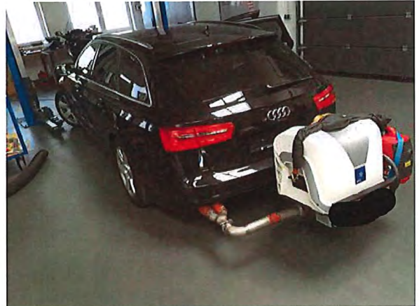
Fahrzeug mit iS-PEMS-System Vehicle with iS-PEMS system
