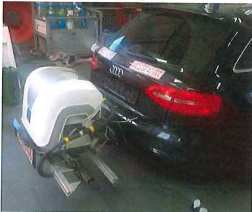
Fahrzeug mit iS-PEMS-System Vehicle with iS-PEMS system
