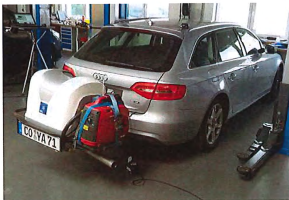
Fahrzeug mit iS-PEMS-System Vehicle with iS-PEMS system
