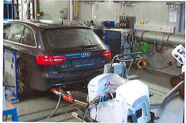
Korrelationstest NEDC Abgasrollenprüfstand NEDC correlation test on exhaust chassis dynamometer
