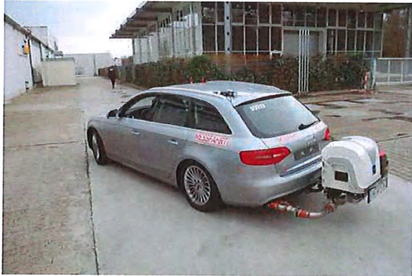
Fahrzeug mit iS-PEMS-System Vehicle with iS-PEMS system
