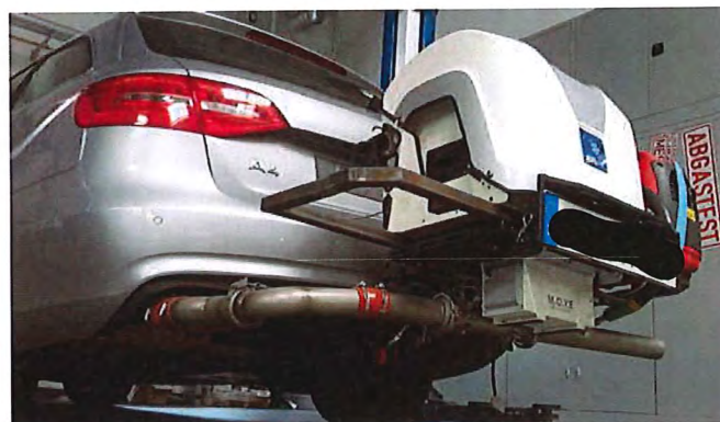
Fahrzeug mit iS-PEMS-System Vehicle with iS-PEMS system
